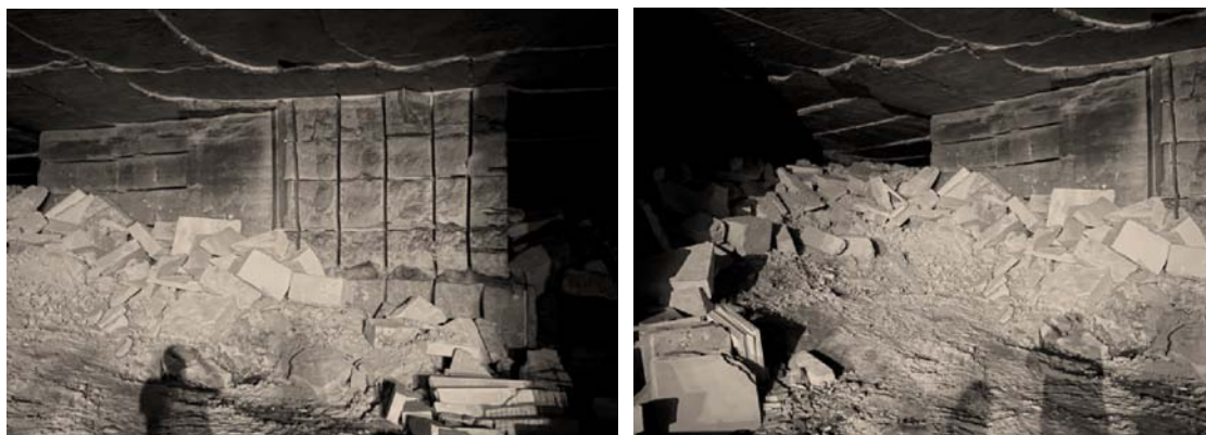
Фиг. 7. Процес на запълване на изчерпаните добивни камери с отпадъци от преработката на блоковете русенски варовик до готови продукти
