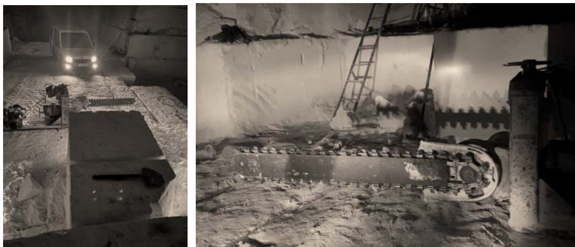
Фиг. 5. Каменорезни машини “Корфман” СТ 100 в добивните камери на подземния рудник за русенски варовик
