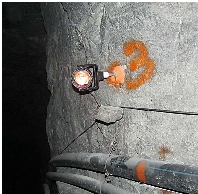
Фиг. 3б – Стенна опорна точка
