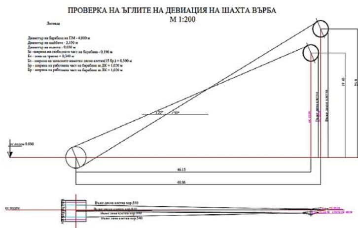
Фиг.7. Проверка на ъглите на девиация на ВШ „Върба-1“
