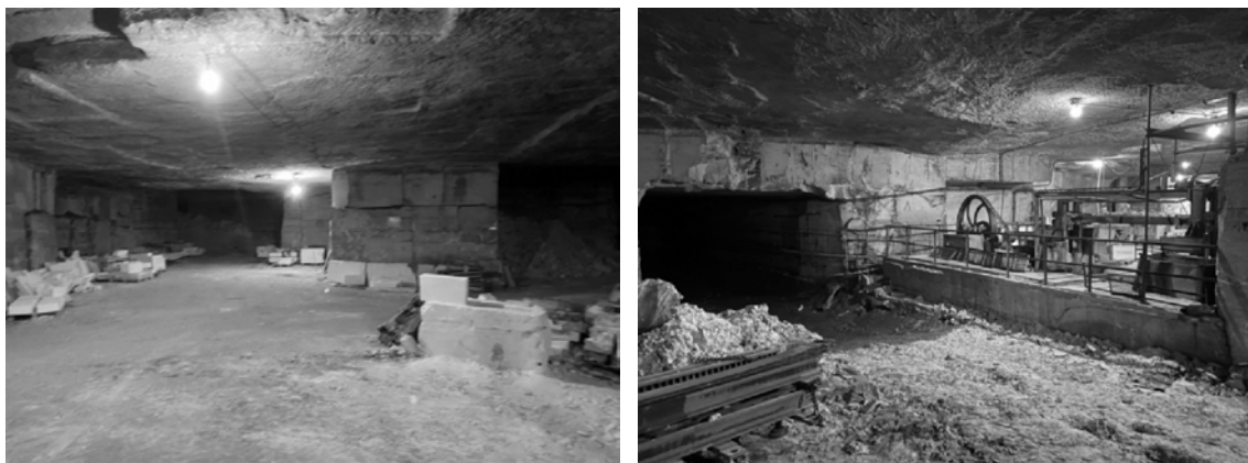
Фиг. 3. Щолнята на рудник за добив на скални блокове "Изгорелица" с гатерното отделение и водохранилище – утаител за технологична вода
